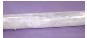
高さ3mより20W蛍光灯落下テスト (モスクリーンカール装着済の場合)
